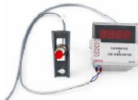
ภาพ 5 เครื่องมือวัดความเร็วรอบ (Proximity sensor) พร้อมจอแสดงผลแบบเรียลไทม์
