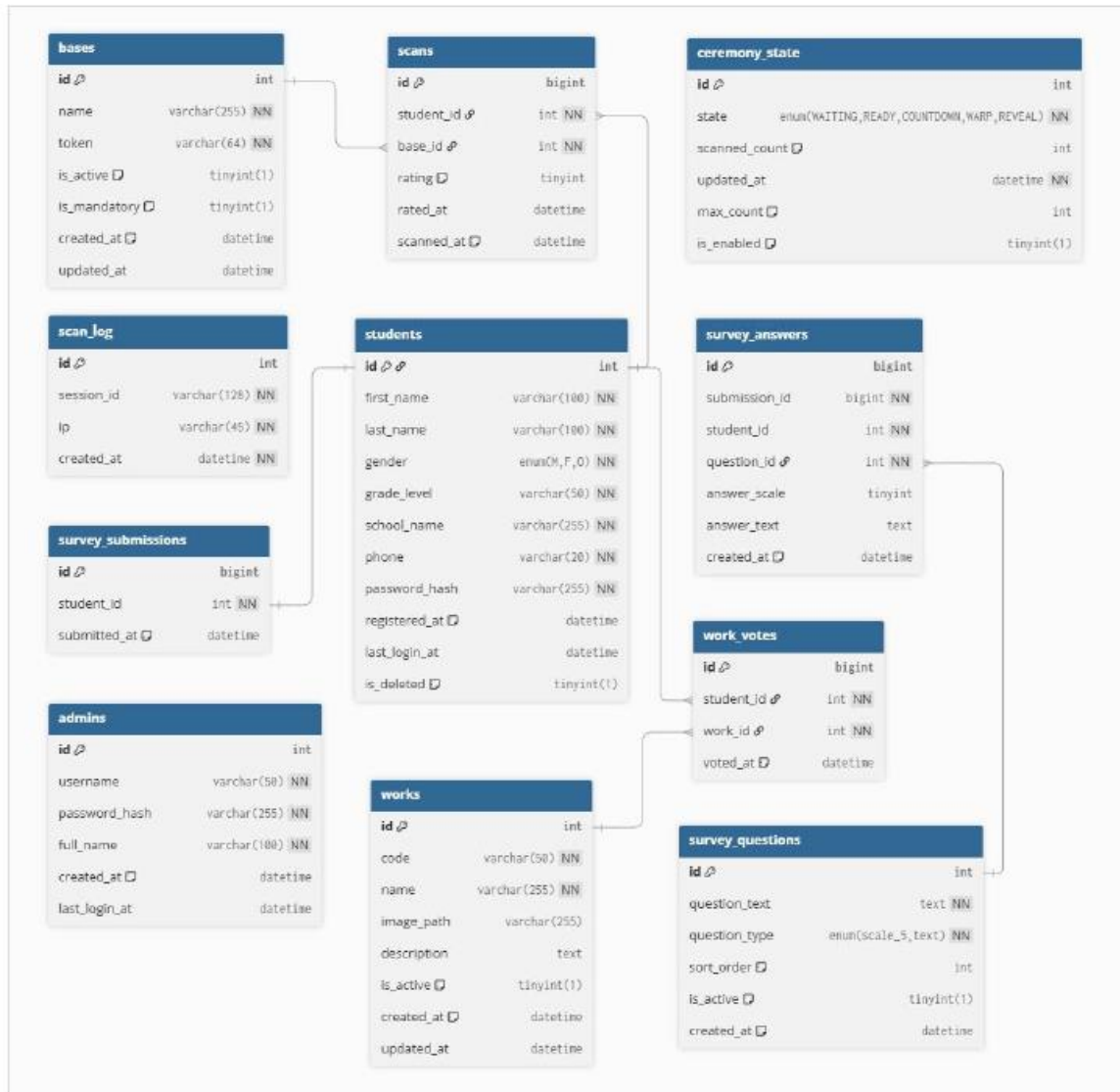
ภาพ 2 แผนภาพความสัมพันธ์ของข้อมูลของระบบดิจิทัลเชิงปฏิสัมพันธ์บนอุปกรณ์เคลื่อนที่เพื่อการบริหารจัดการและประเมินผลการมีส่วนร่วมในกิจกรรม Open House
