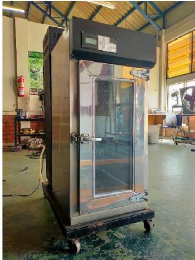
ภาพที่ 1 ชุดทดสอบเครื่องอบแห้งแบบป้อนความร้อน
