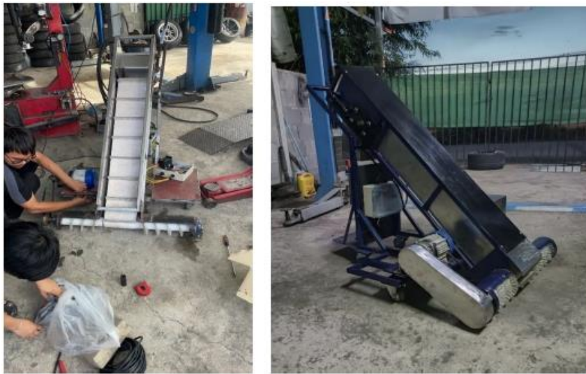
ภาพ 6 ประกอบระบบส่งกำลังและเครื่องประกอบเสร็จสมบูรณ์
