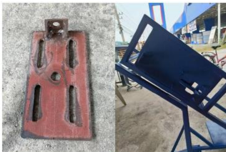
ภาพ 4 การประกอบตัวปรับตั้งสายพานกับโครง
