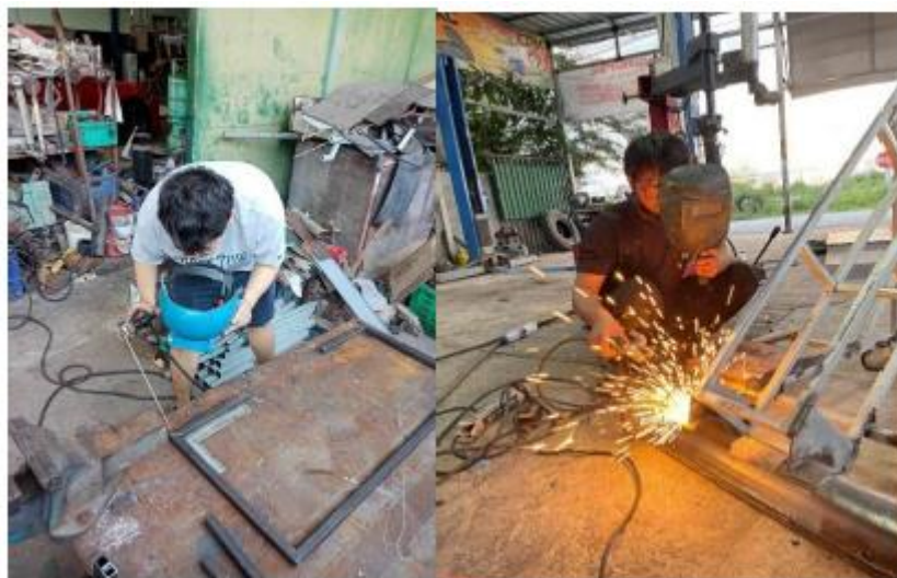
ภาพ 2 การเตรียมท่อและเชื่อมยึดติดกับโครง
