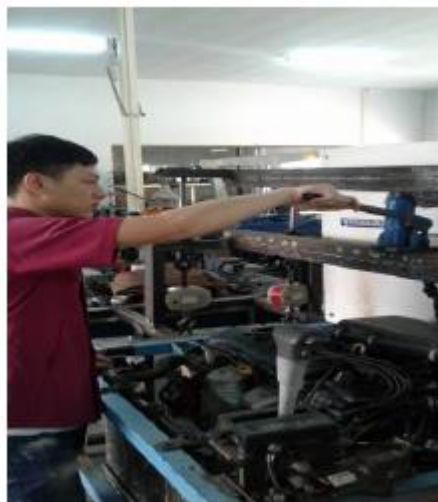
ภาพ 5 แม่แรงไฮดรอลิกส์เพิ่มแรงดึง ของสายพานและผ้าเบรก
