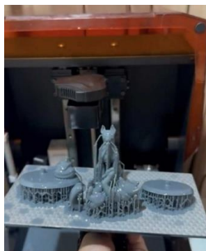
ภาพ 3 แสดงภาพการปริ้นโมเดลด้วยเครื่องพิมพ์เรซิน
