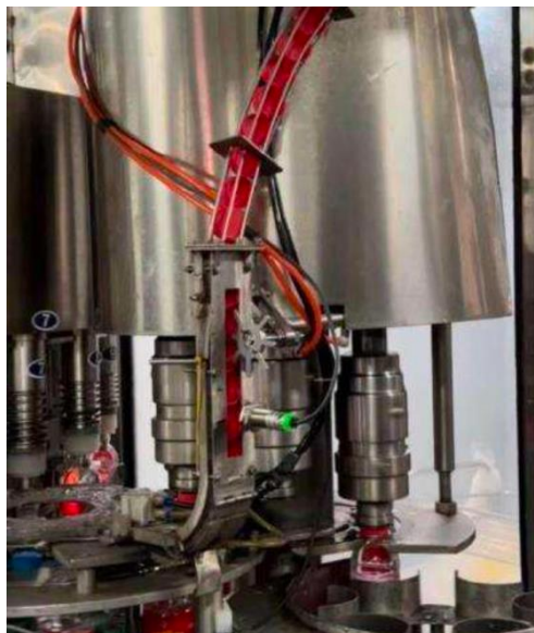
ภาพ 4 เซนเซอร์แสดงสัญญาณไฟสีเขียวเมื่อฝาไหลในทิศทางที่ถูกต้อง
