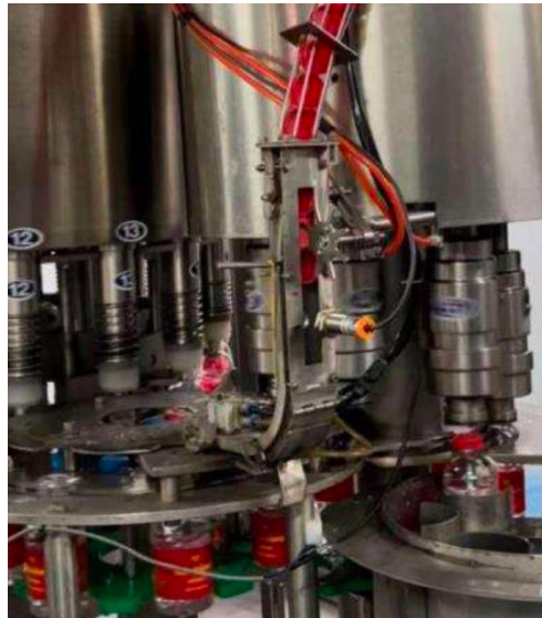
ภาพ 5 เซนเซอร์แสดงสัญญาณไฟสีส้ม เมื่อฝาไหลผิดทิศทาง
