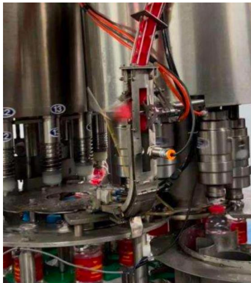
ภาพ 6 Air Cylinder กระทั่งฝาที่ถูกลือออกจากรางส่งฝา
