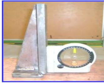
ภาพประกอบ 5 เครื่องมือที่ใช้ตรวจสอบขนาดมุมฉากของ ANGLE PLATE
