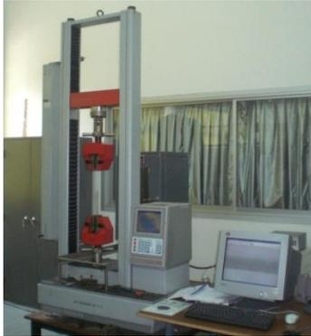
รูปที่ 4 เครื่อง Universal Testing Machine(UTM)
