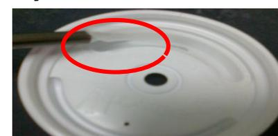
รูปที่ 6 ผลิตภัณฑ์ฝากาแฟแผ่นกรองไม่ติด
