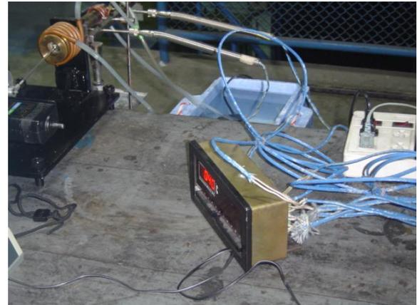
รูปที่ 4.5 แสดงการถ่วงตุ้มน้ำหนักในการวัดแรงบิดของเครื่องยนต์
