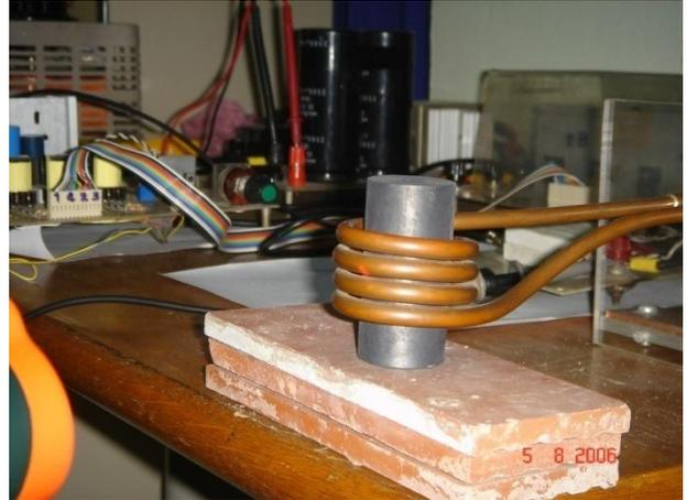
รูปที่ 4.2 รูปภาพขดลวดเหนี่ยวนำทดสอบกับชิ้นงาน
