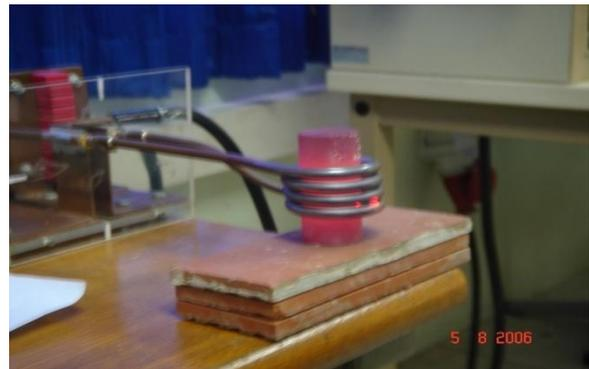
ภาพที่ 8 การชุบแข็งที่อุณหภูมิ 800 องศาเซลเซียส
