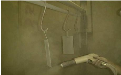
จากรูปที่ 7 แสดงการทำงานของเครื่องพ่นสี
