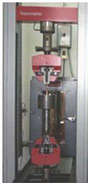
รูปที่ 5 ชุดหัวจับด้ายซึ่งเป็นอุปกรณ์ที่สร้างขึ้นมาเป็น
