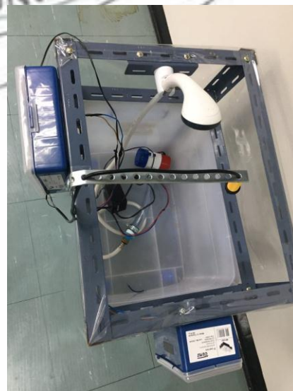
รูปภาพที่6 ภาพรวมของระบบฝักบัวอัจฉริยะสำหรับผู้พิการทางการเคลื่อนไหวและผู้สูงอายุ
