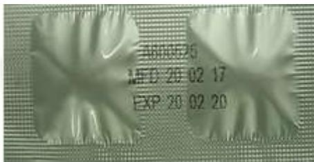
รูปที่ 10 เครื่องพิมพ์ Laser Inject เปลี่ยนใหม่ รูปที่ 11 ตัวเลขพิมพ์ Lot no. จากเครื่องพิมพ์ Laser Inject ยี่ห้อ Domino รุ่น G320I
