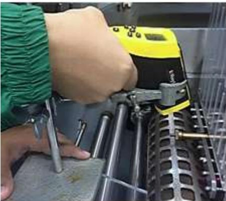
รูปที่ 8 วัดอุณหภูมิ Roller Sealing จากเครื่อง Infrared Thermometer
