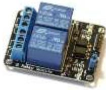
รูปที่ 4 Relay Module ที่ใช้ควบคุมอุปกรณ์ไฟฟ้า
