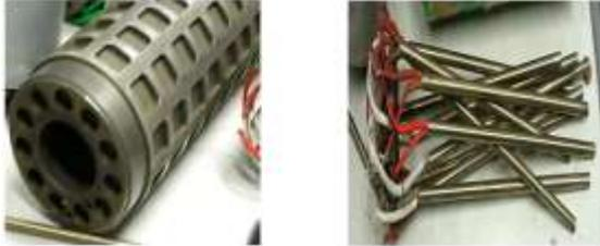
รูปที่ 7 Roller Sealing และฮีตเตอร์ ที่เกิดการชำรุด
