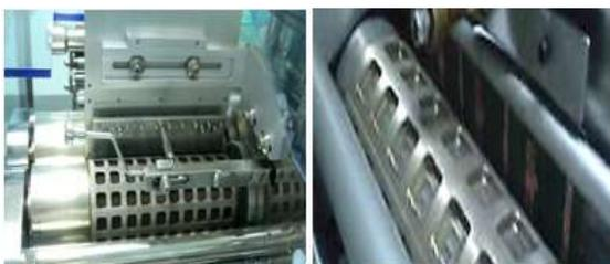
รูปที่ 9 ชุด Roller Sealing ที่ทำการแก้ไข
