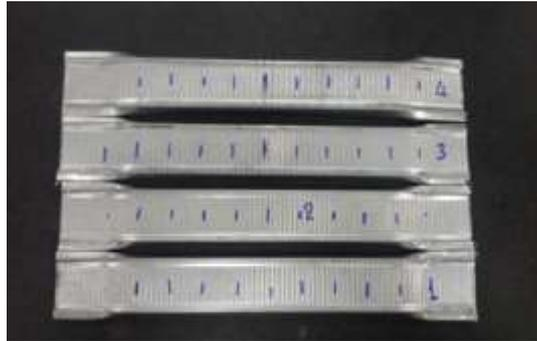
รูปที่ 7 รูปชิ้นงานที่เตรียมทดสอบแรงดึง
