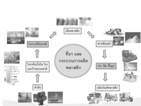
รูปที่ 2 ที่มาและกระบวนการผลิตพลาสติกทั่วไปจากปิโตรเลียม
