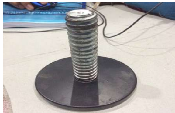
รูปที่ 3.18 สดัดเกลียวแม่แรง (คางหมู) ใช้สำหรับปรับยกระดับ
