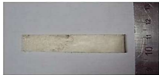
รูปที่ 8 ชิ้นงานทดสอบสมบัติการทนแรงกระแทก
