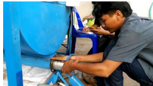
รูปที่ 12 การสวมถุงพลาสติกเข้ากับชุดอัดบรรจุ
