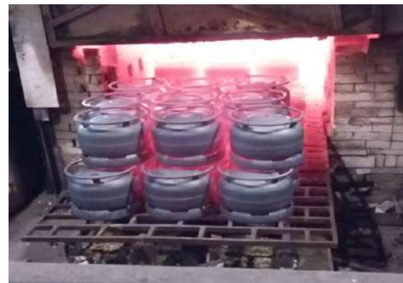
รูปที่ 7 แสดงขั้นตอนการเผาให้ความร้อน
