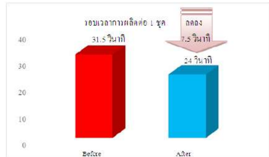
รูปที่ 5 แสดงการเปรียบเทียบรอบเวลาการผลิต
