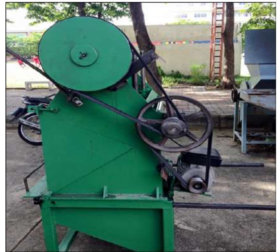
รูปที่ 2 แสดงชุดส่งกำลังของเครื่องอัดเศษกลึง
