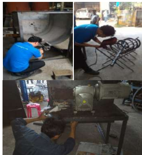
รูปที่ 5 การประกอบโครงสร้าง เครื่องผสมพร้อมอัดบรรจุก้อนเชื้อเห็ดและการเชื่อมติดยึดใบผสมแบบเส้นแถบเหล็กคู่ (Double Ribbon Mixing Blades)
