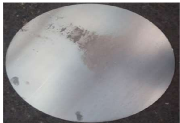
รูปที่ 1 เหรียญ (Bank) ที่ได้จากการตัดเหล็ก SG295
