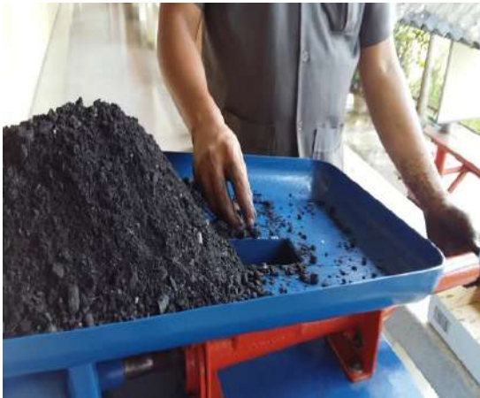
รูปที่ 10 แสดงการป้อนถ่านเข้าช่องอัดถ่าน
