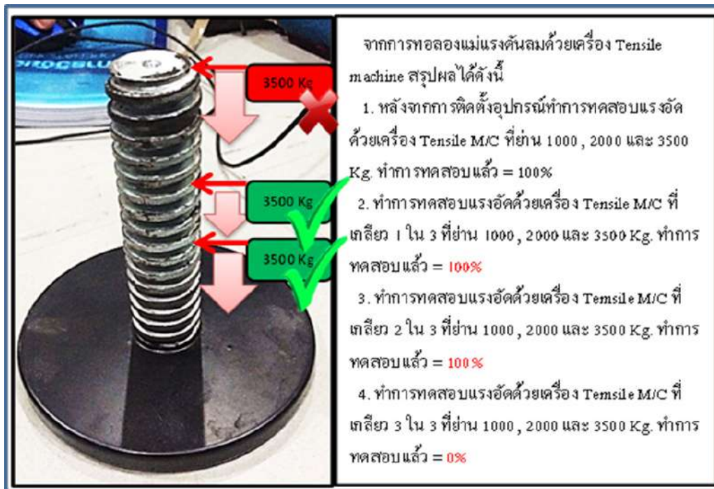
รูปที่ 4.4 มาตรฐานความปลอดภัยในการปรับตั้งระยะของแม่แรงลมด้วยสัดเกลียวแม่แรงลม
