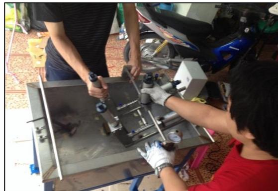
รูปที่ 6 ติดตั้งอ่างบรรจุน้ำและชุดกระบอกสูบนิวแมติกส์
