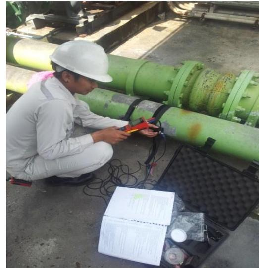
รูปที่ 7 การตรวจวัดอัตราการไหลของน้ำกลับ
