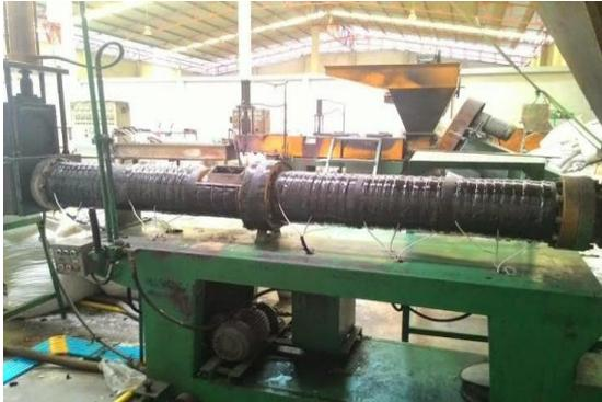
**รูปที่ 24** การทดสอบหลอมพลาสติกด้วยขดลวดความร้อนแบบเหนี่ยวนำในงานอุตสาหกรรม
