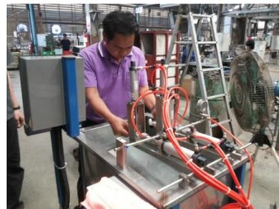
รูปที่ 11 ทดสอบเวลาที่ใช้ต่อชิ้นในหนึ่งวัฏจักรการทำงานของเครื่องที่สร้างขึ้นใหม่
