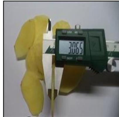
รูปที่ 7 ขนาดความหนาของชิ้นงานแบบแผ่นที่ความเร็วรอบ 600 rpm
