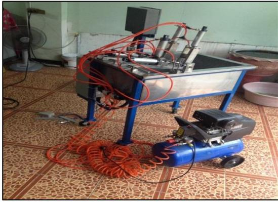
รูปที่ 8 เตรียมทดสอบระบบการทำงานของเครื่องทดสอบรอยร้าวสุษกัณฑ์หัวฉีดชำระ
