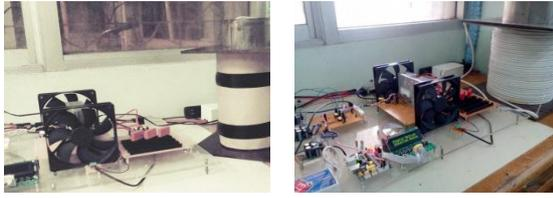
ก)ขดลวดความร้อนแบบรัดท่อ ข)ขดลวดเหนี่ยวนำความร้อนรูปที่ 21 การทดสอบหลอมด้วยขดลวดความร้อนแบบรัดท่อและขดลวดเหนี่ยวนำ
