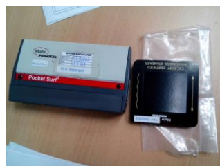
รูปที่ 6 เครื่องตรวจสอบค่าความเรียบผิว (Surface roughness tester)
