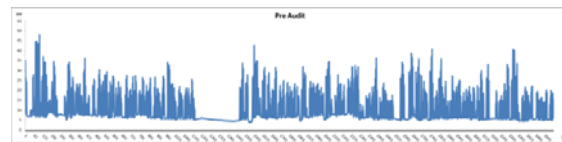
รูปที่ 3 การใช้พลังงานปกติของเครื่องเลื่อยไม้ซุง
