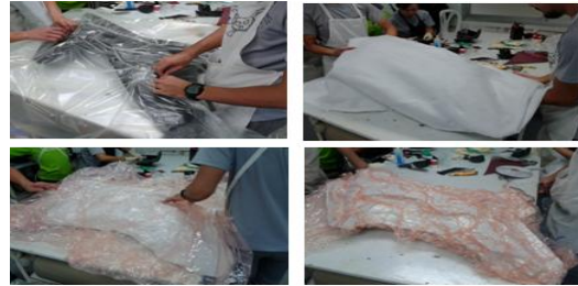
รูปที่ 7 รายละเอียดการจัดสร้างแม่พิมพ์
