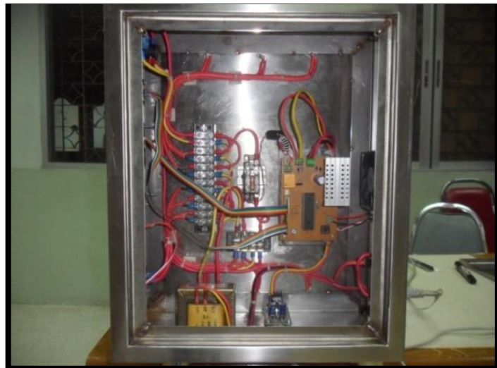
รูปที่ 2 วงจรฆ่าเชื้อโรคด้วยหลอดอัลตราไวโอเล็ต
