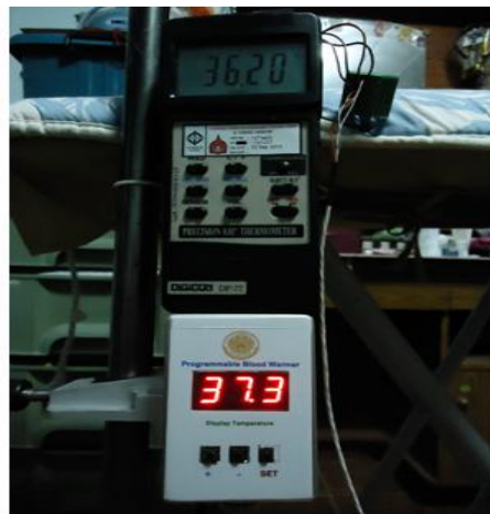
รูปที่ 5 การเปรียบเทียบเครื่องควบคุมอุณหภูมิของเลือด ผลิตโดยบริษัท และเครื่องที่สร้างขึ้นเอง
