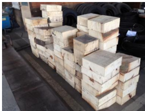
ภาพที่ 6 ไม้มะขามที่เป็นแผ่นเดียวหลาย ๆ ขนาดสำหรับรองหัวเสาเข็มขณะตอก
