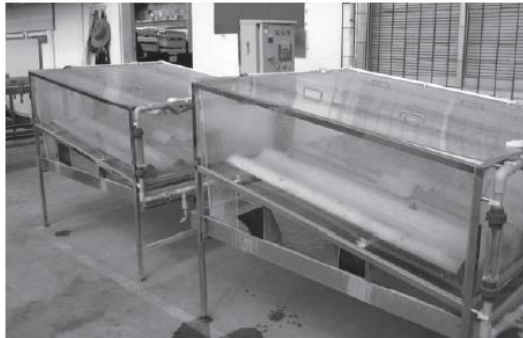
รูปที่ 3 การทดสอบความทนความร้อน-ฝน
