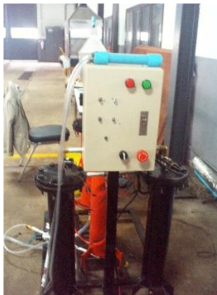
รูปที่ 1 ชุดทดลองดักจับก๊าซคาร์บอนไดออกไซด์
