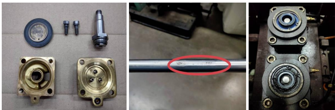
ภาพ 5 ชิ้นส่วนอุปกรณ์ที่ชำรุดของเครื่องเป่าขวดพลาสติก
