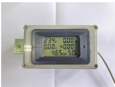
ภาพ 6 อุปกรณ์ Power Meter รองรับกระแสสลับ AC 20A (110-250V AC), 4400W
