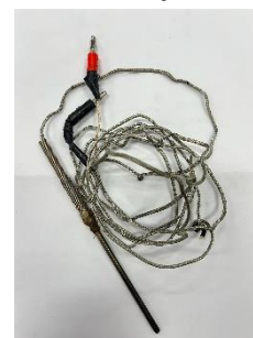
ภาพ 7 Thermocouple Type K ใช้จับวัดอุณหภูมิของฮีตเตอร์
