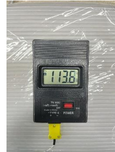
ภาพ 3 อุปกรณ์วัดอุณหภูมิ TM-902C วัดอุณหภูมิได้ตั้งแต่ -50 – 1,300 องศาเซลเซียส
