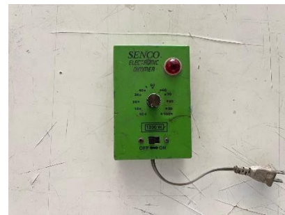
ภาพ 5 เครื่องมือปรับกำลังไฟฟ้า ปรับกำลังไฟฟ้าได้สูงสุด 700 วัตต์
