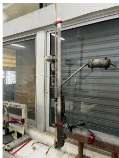
ภาพ 4 เครื่องมือวัดการกระเพื่อมของน้ำ ใช้ไม้บรรทัดฟุตเหล็ก ความยาว 1 เมตร
