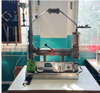
ภาพ 2 เครื่องยนต์ฟลูอิดที่ใช้ในการทดลอง ใช้ฮีตเตอร์ไฟฟ้าเป็นแหล่งให้ความร้อน
