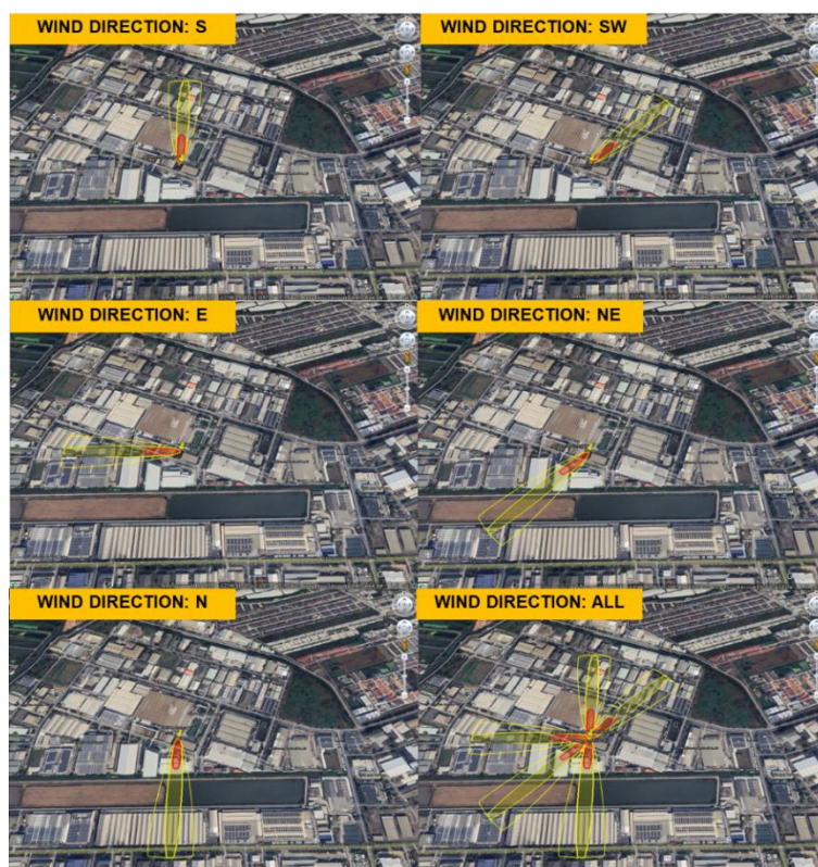
ภาพ 5 แบบจำลองการรั่วไหลของสารทำความเย็น R290 แบบกลุ่มหมอกก๊าซไวไฟบนโปรแกรม Google earth โดยลมพัดจากทิศทิศใต้ (S) ทิศตะวันตกเฉียงใต้ (SW) ทิศตะวันออก (E) ทิศตะวันออกเฉียงเหนือ (NE) และทิศเหนือ (N) แบบแยก และการแพร่กระจาย
