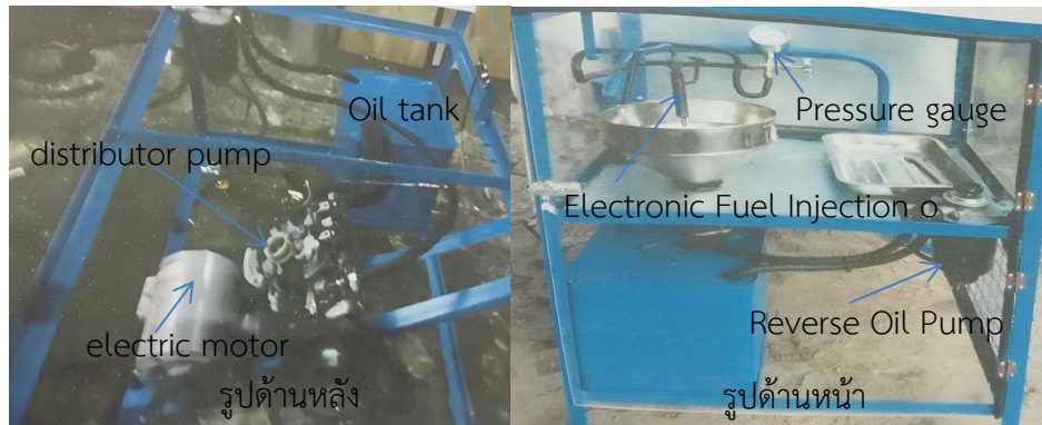
ภาพ 4 แสดงลักษณะของเครื่องทดสอบสมรรถนะหัวฉีดตามค่ามาตรฐานที่กำหนดจากเต้ารถยนต์
